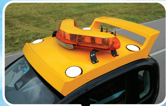
Two sets of white circular-shaped DGPS on the APC's roof. 無人巡邏車車頂裝設兩組白色的圓形差分全球定位系統。
